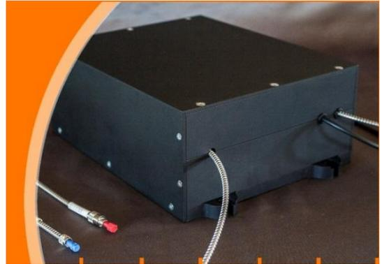
Im UVM-F/2 erzeugt ein korrigiertes abbildendes Gitter mit der Öffnung F/2 ein Spektrum von 25mm Länge, welches direkt mit der Auskoppelfaser abgefahren wird. Bürstenlose Motoren erlauben den Scanning-Dauerbetrieb. Die Ansteuerung erfolgt über eine USB-Schnittstelle mit LabVIEW™ Software.
